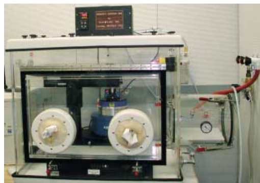
Abbildung 13. Kraftfeldmikroskop (Park Scientific AutoProbe CP Research) in einer feuchtigkeitsregulierbaren Glove Box (PlasLabs) zur Ausführung von DPN-Experimenten.
